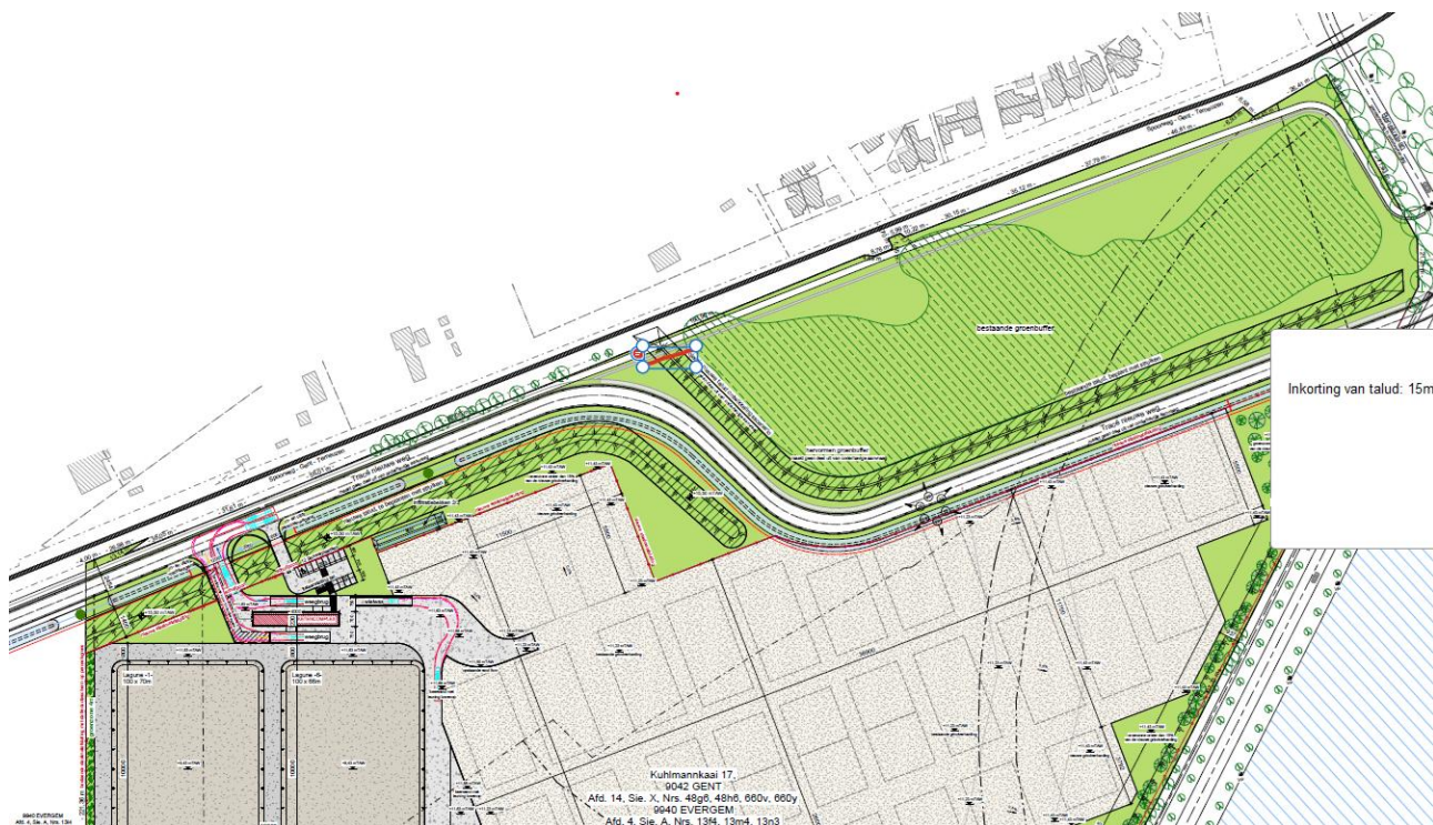
Figuur 2. Weergave inkorting van het talud.
