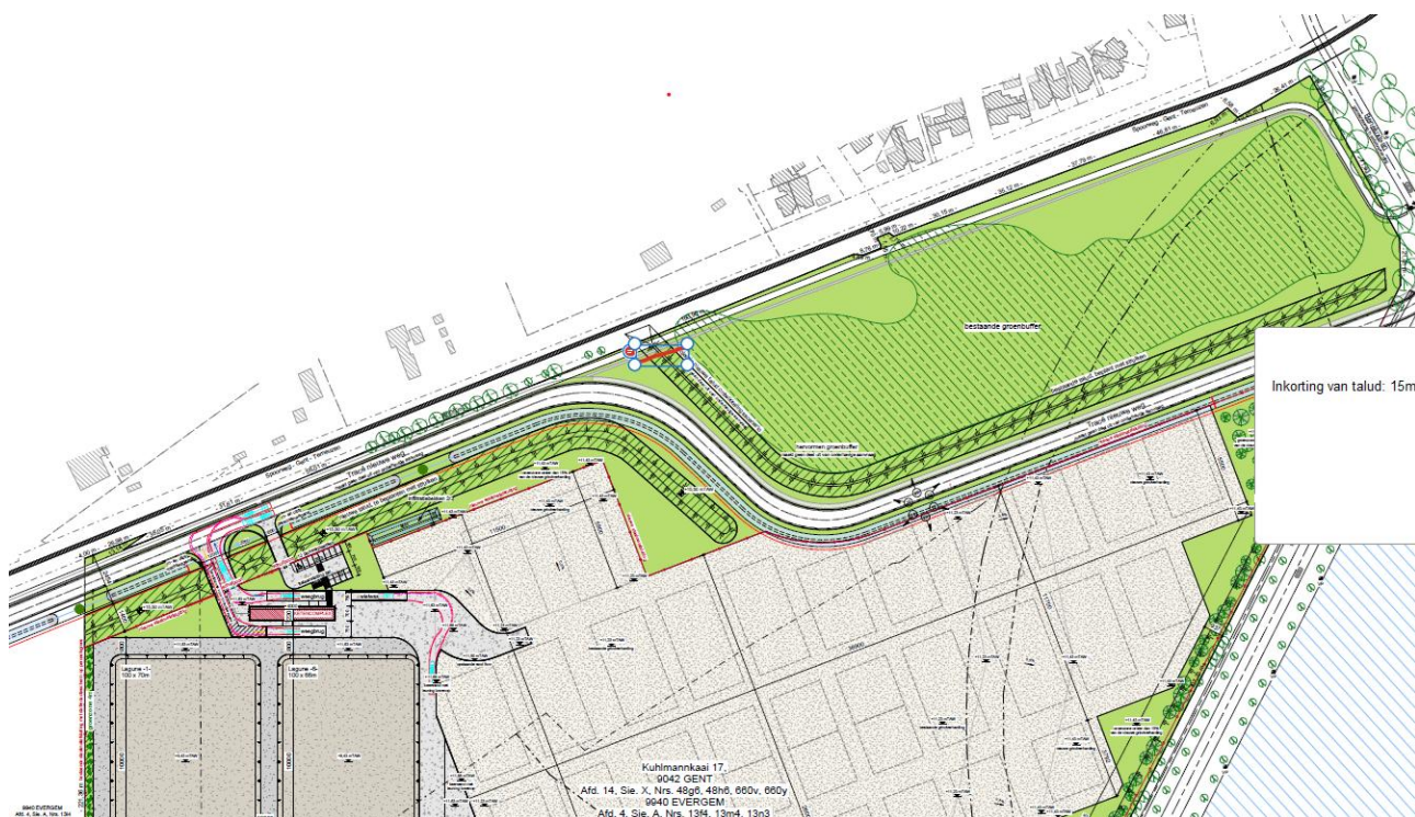
Figuur 2. Weergave inkorting van het talud.
