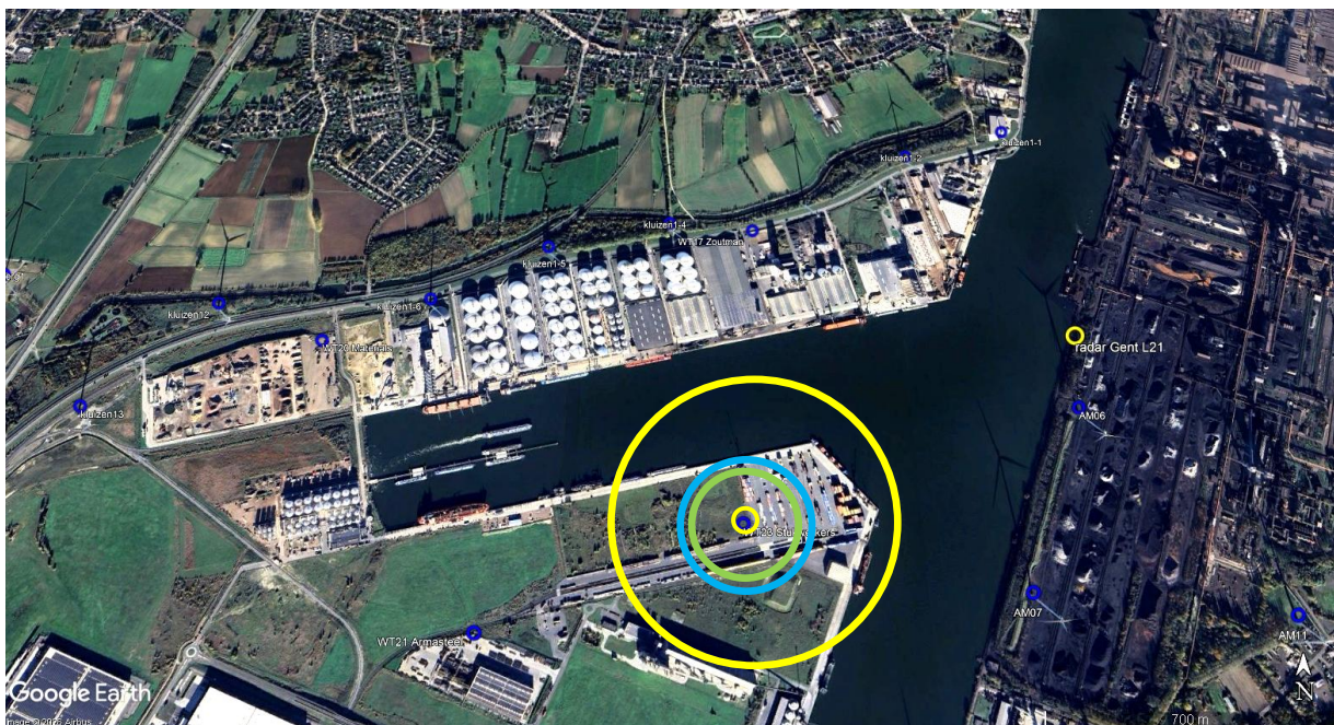
Figuur 40. Zones rond de WT voor meervoudige reflectie type 2&4 voor de havenradar L21
