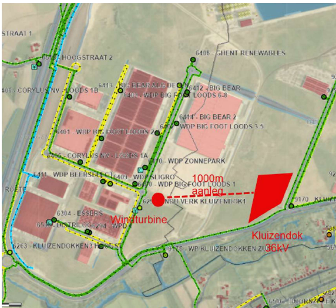
Figuur 3-2: Schematische voorstelling van aansluiting op nieuw te bouwen transformatorstation (bouw voorzien in 2028-2029) (bron uit uittreksel van de oriëntatie studie van Fluvius)
