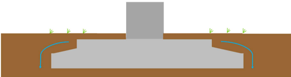
Figuur 2-8: Afvoer hemelwater bij een ondergrondse fundering.
