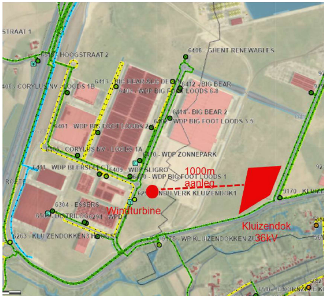
Figuur 3-1: Schematische voorstelling van aansluiting op nieuw te bouwen transformatorstation (bouw voorzien in 2028-2029) (bron uit uittreksel van de oriëntatie studie van Fluvius)
