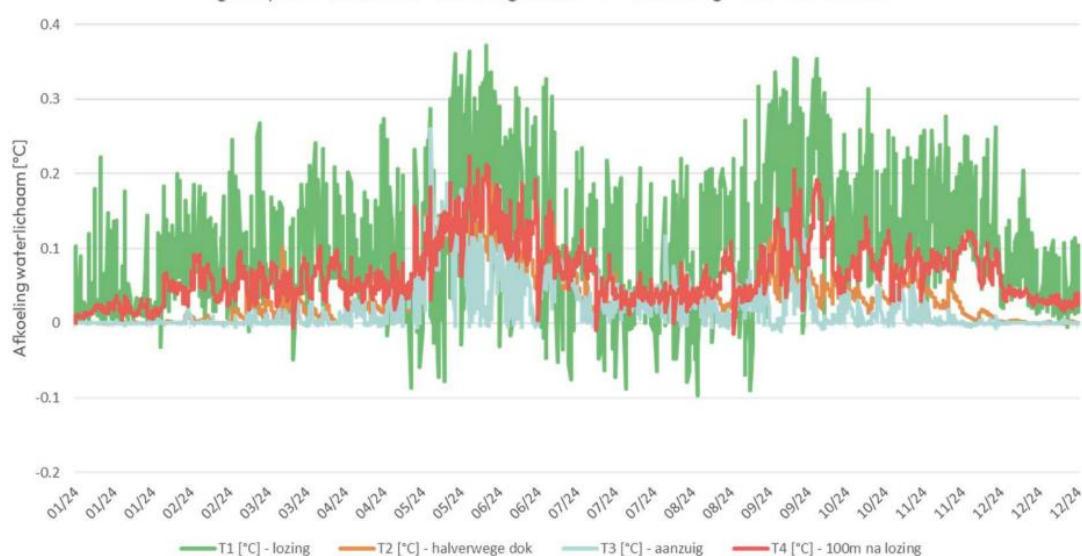
FIGUUR 8.12 TERMPERATUURVERSCHIL IN WATERLICHAAM IN GEPLANDE SITUATIE (HERVERGUNNING) T.G.V. LOZING KOELWATER
