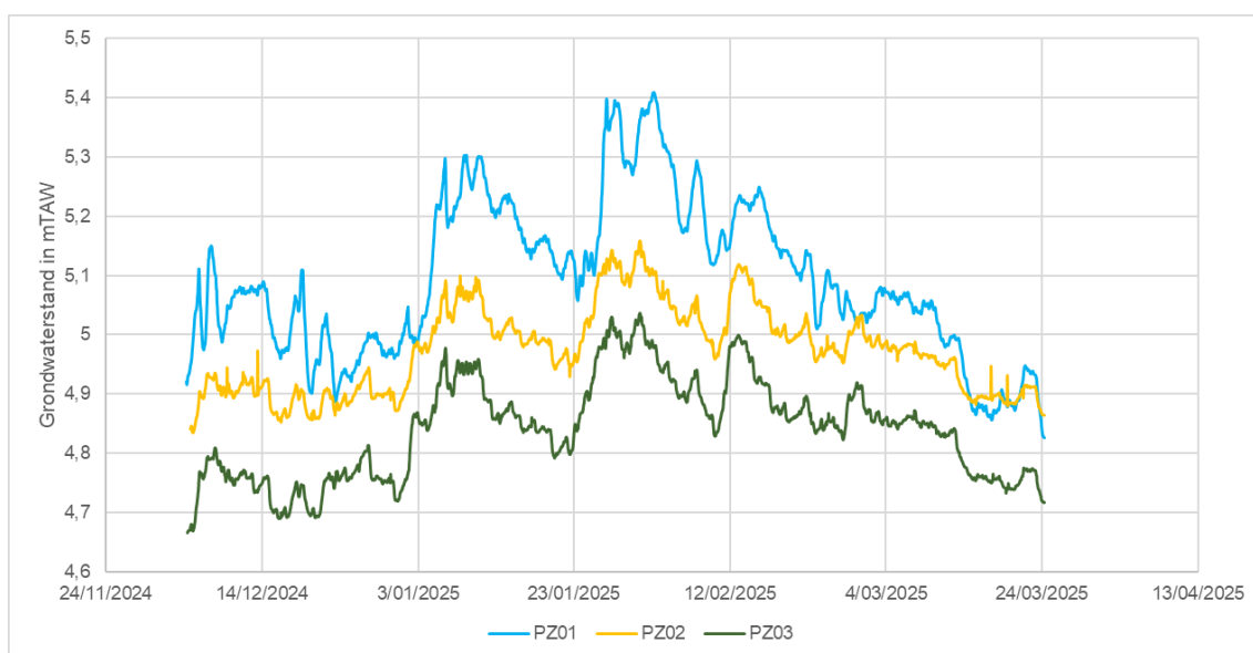
Figuur 3: Continue grondwaterstandsmeting
