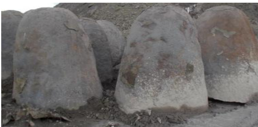
Figuur 1: Verschillende “steel skulls” in de “scrap yard” van ArcelorMittal.
