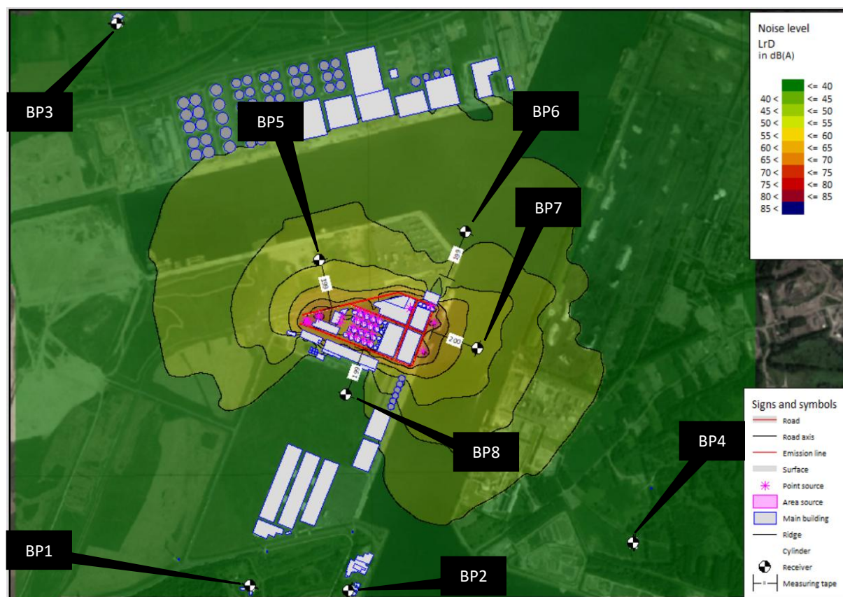
Figuur 8: Isocontourkaart van de relevante waarde voor de nachtperiode in de geplande situatie
