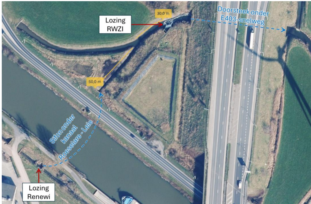
Afbeelding 5.1 Situering van de lozing van Renewi Roeselare en RWZI Roeselare (bron: Geopunt)
