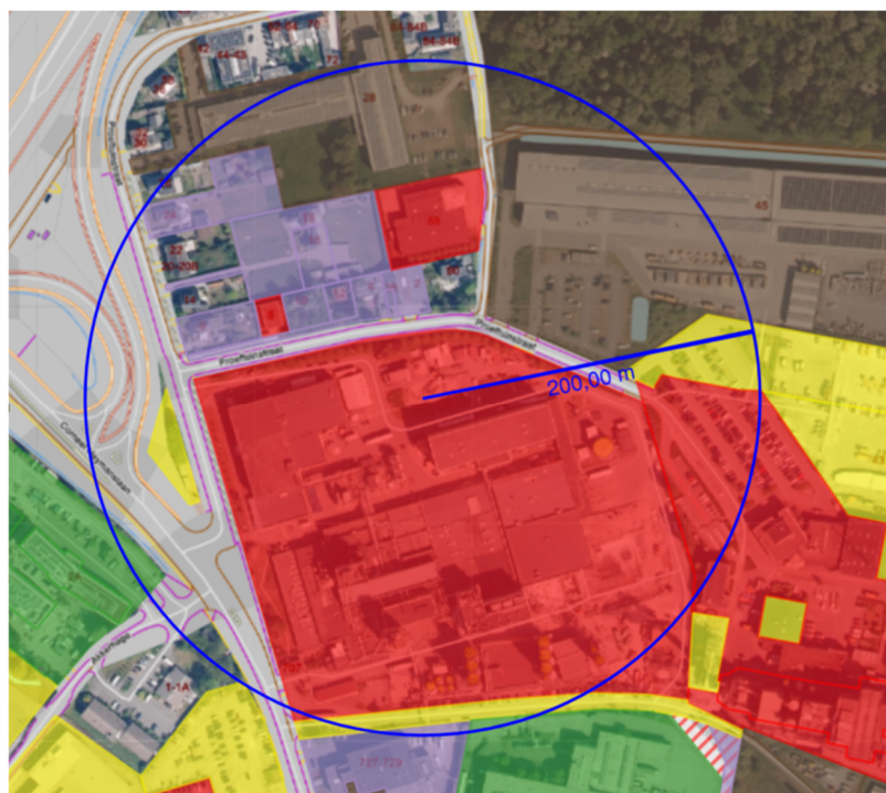
Figuur 5-5. Uitspraak bodemonderzoeken en aanwezigheid risicogronden binnen de maximale invloedsstraal (OVAM-dossierinformatie, dov.vlaanderen.be geraadpleegd 05/12/2025). Blauwe lijnen geven schematisch invloedsstraal weer.
