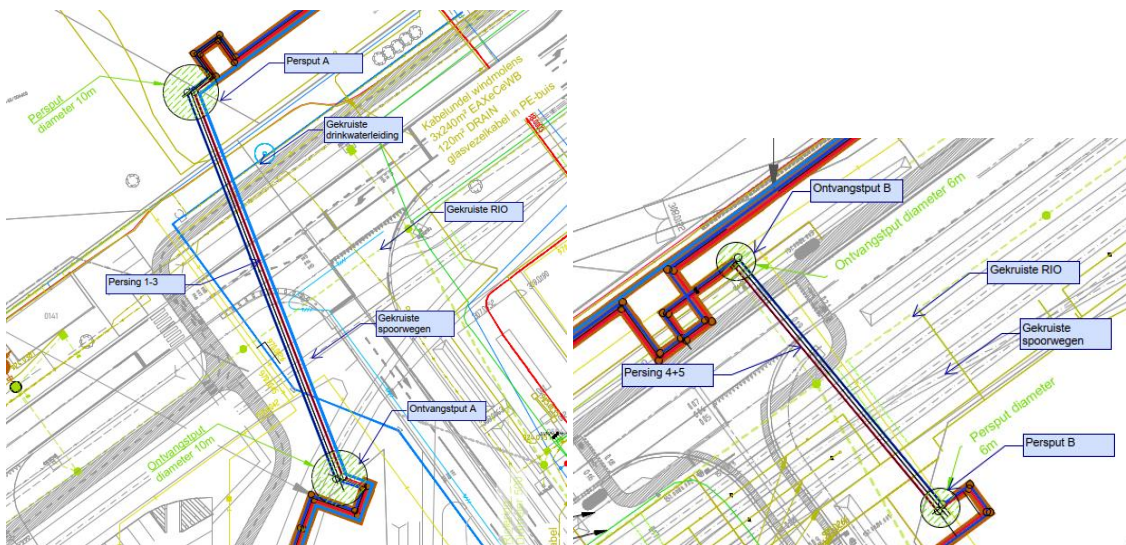
Figuur 1: Inplanting persingen, pers- en ontvangstputten t.o.v. infrastructuur. (merk op dat de tussenafstand van de persingen nog niet op schaal getekend is)
