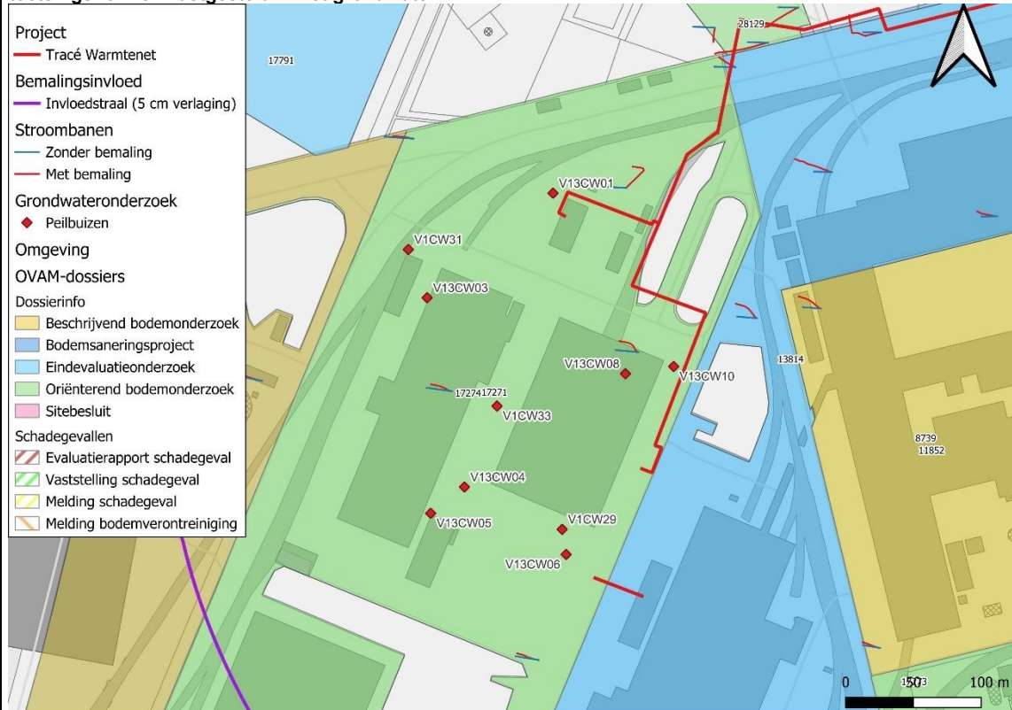
Figuur 39 Overzicht peilbuizen (cfr. dossier 17274 – OBO 2013)
