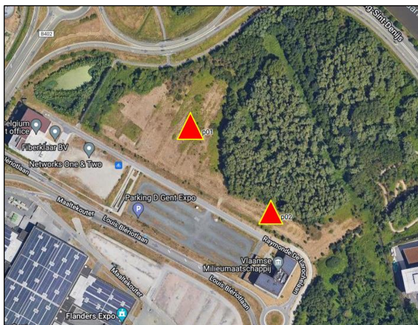
Figuur 9-1: Grondwatermonitoring binnen de invloedstraal van de bemaling.
