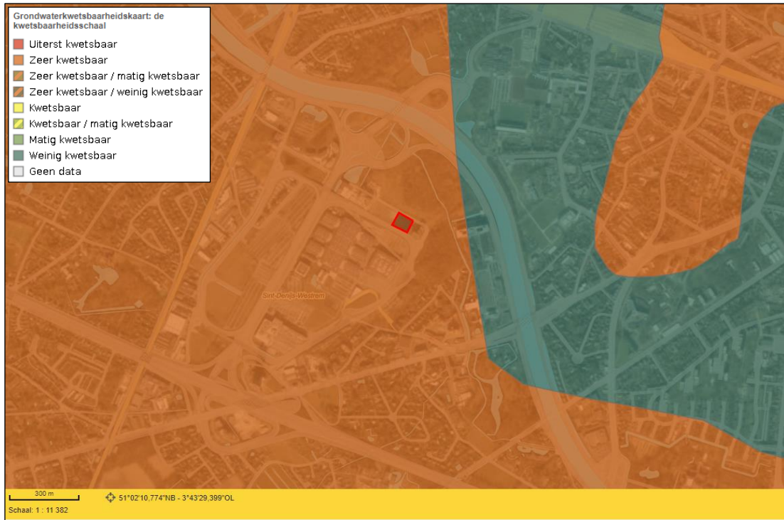
Figuur 3-4: Grondwaterkwetsbaarheidskaart met aanduiding van de bouwputlocatie (bron: Geopunt).
