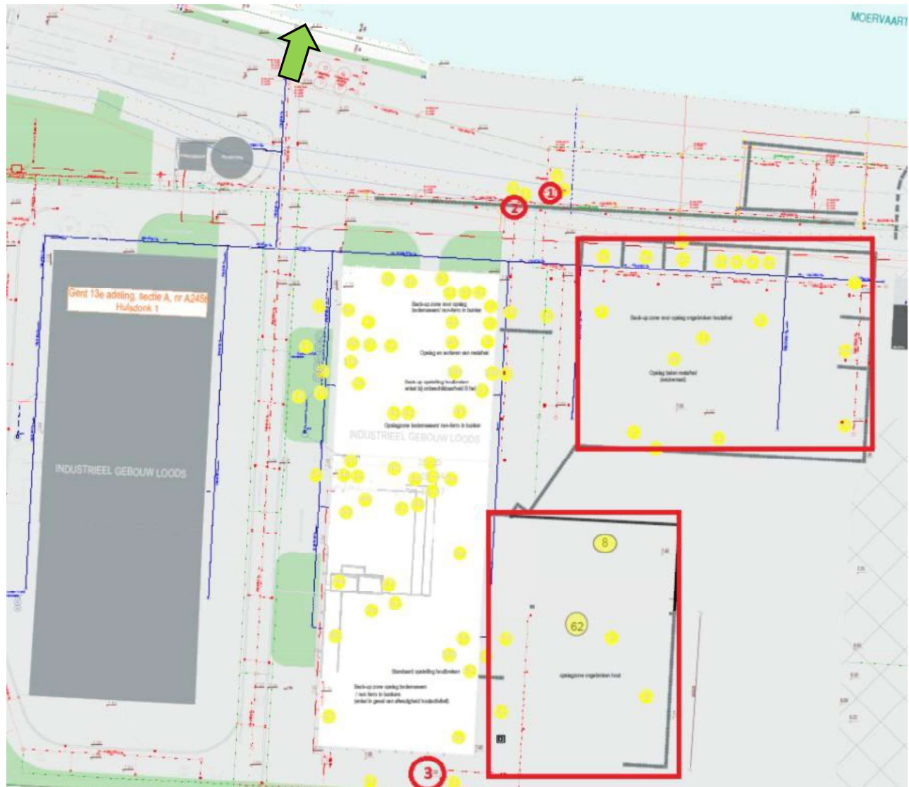
Figuur 3-1: Bedrijventerrein Veolia Environmental Services BE met indicatie van het lozingspunt (groene pijl), de 3 slibvang/Kws-afsciederders met controleput (nrs. 1-3) en de buitenterreinen (rood omkaderd)
