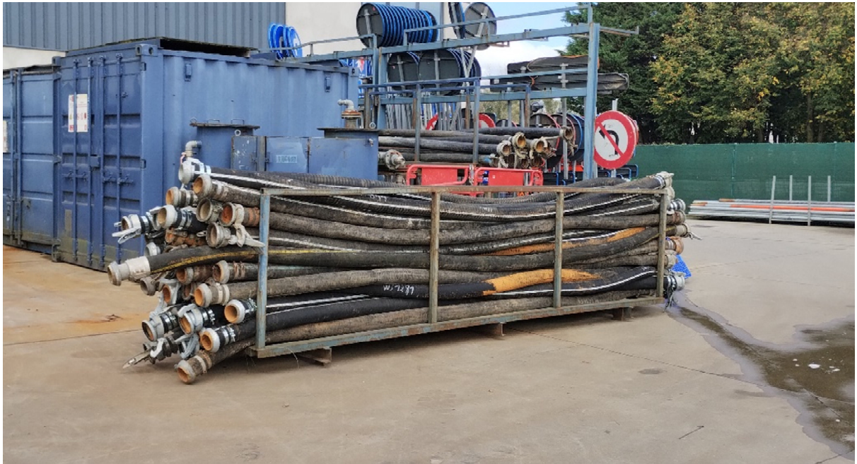
Figuur 7: Werfslangen na spoeling en schadecontrole
