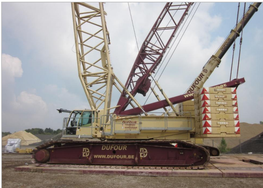
Figuur 33: Kraan op kraanplatform
