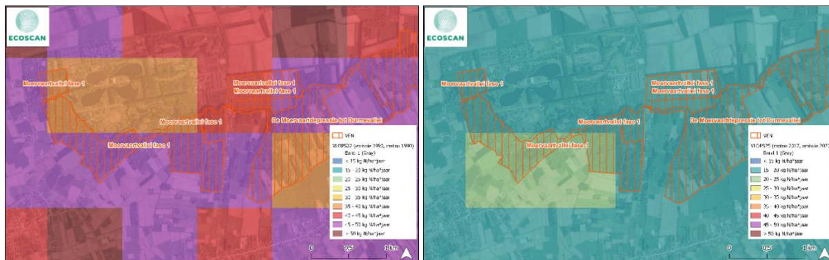
Figuur XIV-11: Evolutie van de vermistende depositie ter hoogte van het dichtstbijgelegen onderdeel van het VEN-gebied "Moervaarvallei fase 1" o.b.v. VLOPS22 (emissie 1990, meteo 1990) (links), VLOPS25 (emissie 2023, meteo 2017) (rechts)
