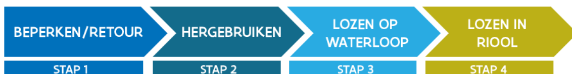
Figuur 42: Stappenplan bemaling (VMM)
