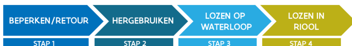
Figuur 42: Stappenplan bemaling (VMM)
