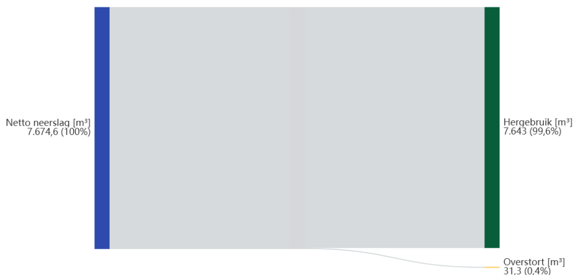
Figuur 8 Resultaat van de Siriomodellering van de geplande hemelwatervoorzieningen
