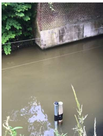
Figuur 18: peilbuis spoorwegbrug werd in de beek aan de spoorwegbrug geplaatst, net na het punt waar het opgepompt water wordt geloosd (foto Eijkelkamp).
