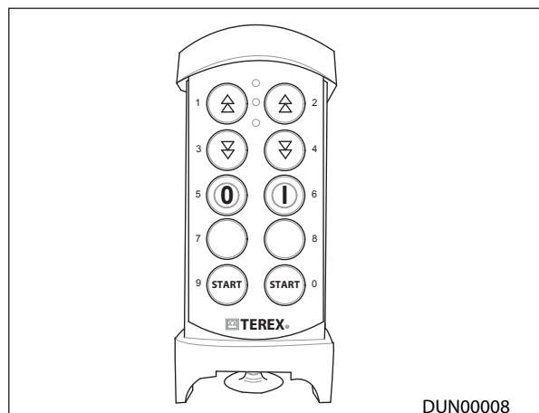
Figure 4.22 - Lay-out draadloze afstandsbediening
