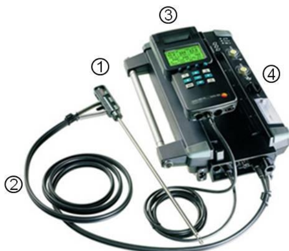
Figuur 3: Meetopstelling voor gasanalyse met electrochemische cellen
