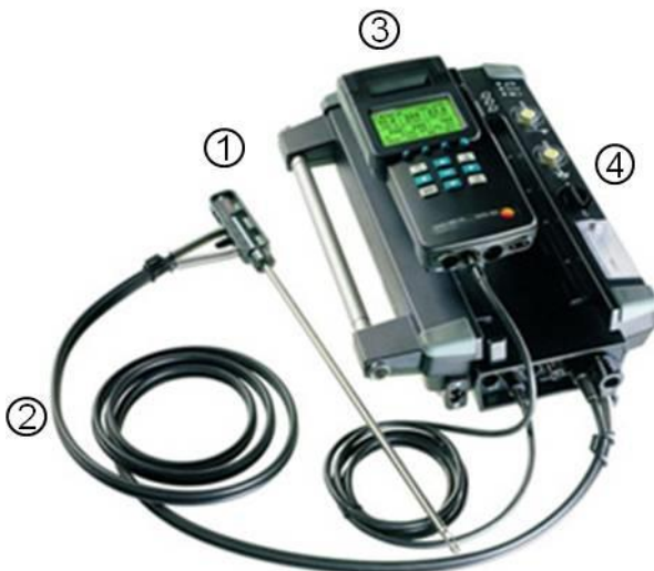
Figuur 3: Meetopstelling voor gasanalyse met electrochemische cellen
