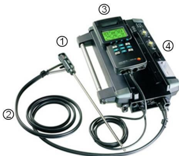
Figuur 3: Meetopstelling voor gasanalyse met electrochemische cellen
