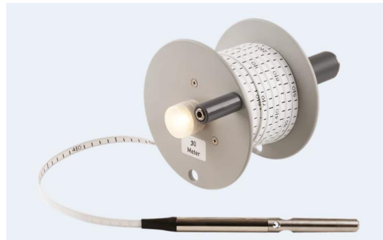
Figuur 2-9: Peilapparaat voor de grondwatermetingen.
