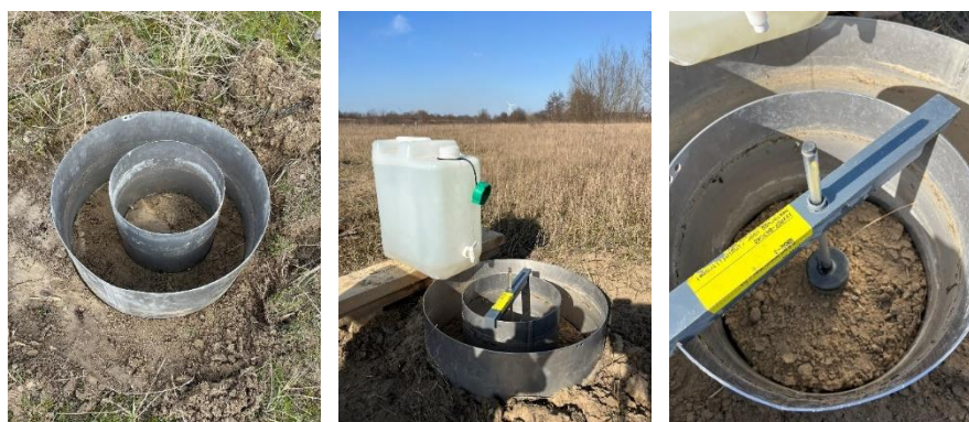
Figuur 1-7: Opstelling infiltratieproef.
