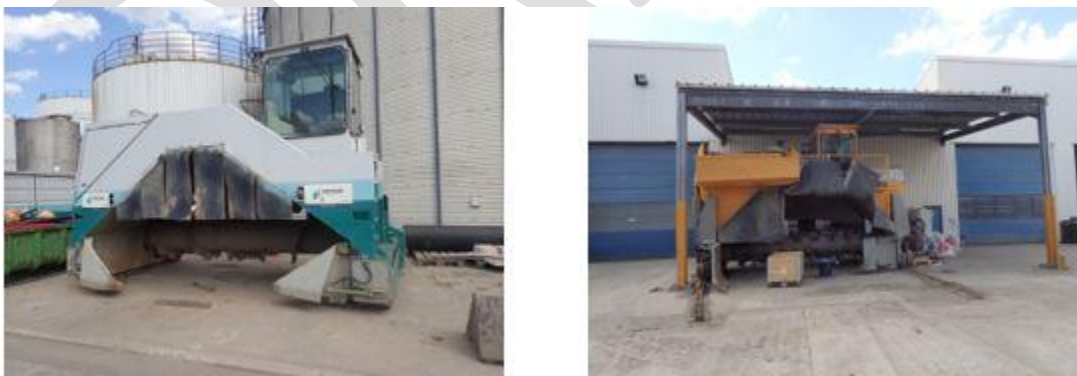
Figuur 10: Biologische reiniging: machines voor omwoeling/inmenging
