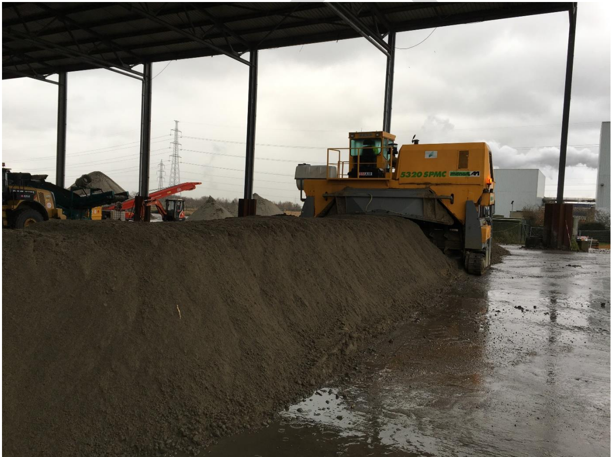
Figuur 3: Mengen van materialen met woelmachine
