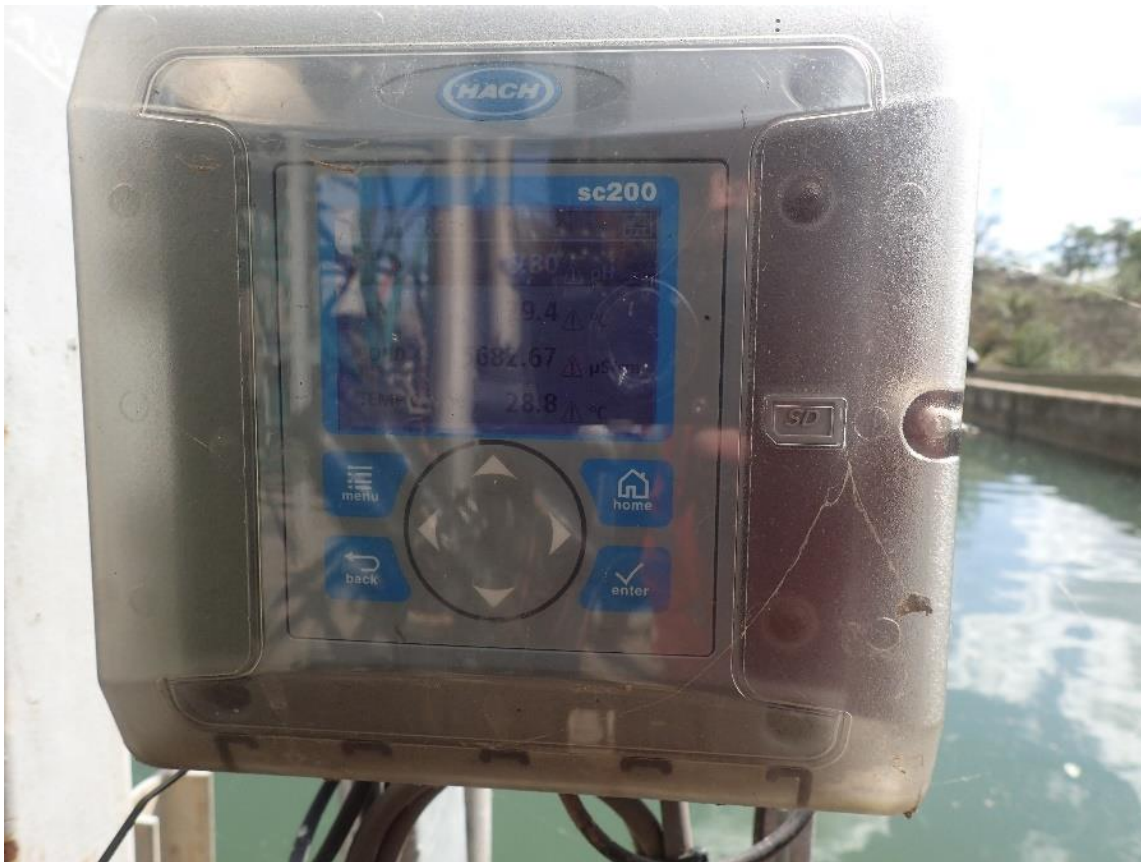
Figuur 8: Meettoestel kwaliteitsmeting
