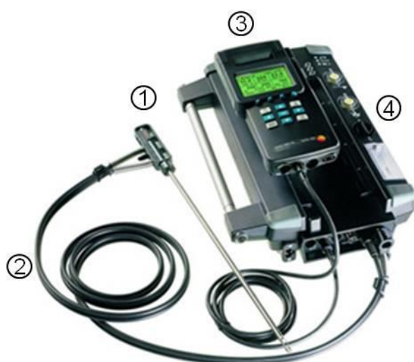
Figuur 2: Meetopstelling voor gasanalyse met electrochemische cellen
