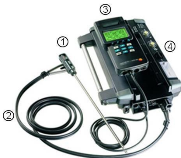
Figuur 2: Meetopstelling voor gasanalyse met electrochemische cellen
