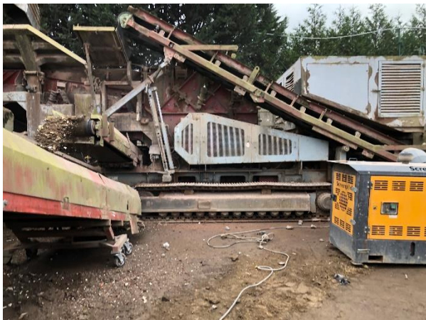
figuur 5: zij aanzicht brekinstallatie
