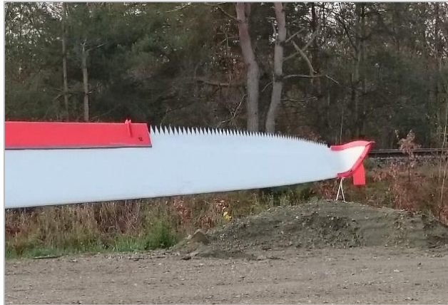
Figuur 26: Serrations op het uiteinde van de wiek
