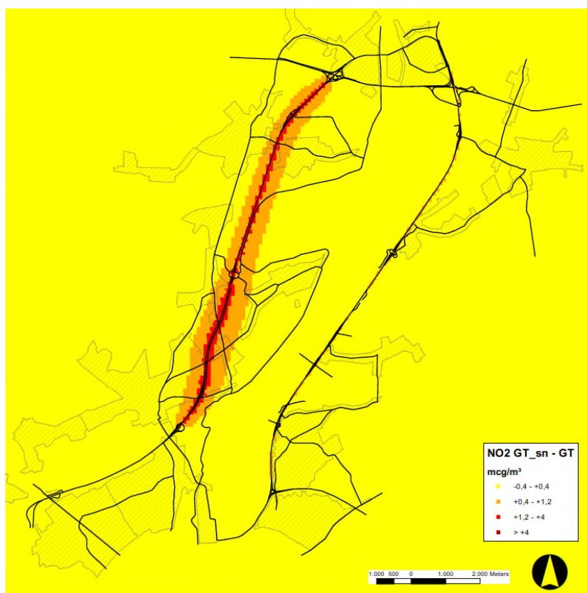
Figuur 7-13 Verschil NO2 scenario met hogere snelheid op delen van de R4 t.o.v. referentiesituatie (boven) en t.o.v. basisscenario (onder) volgens IFDM Traffic
