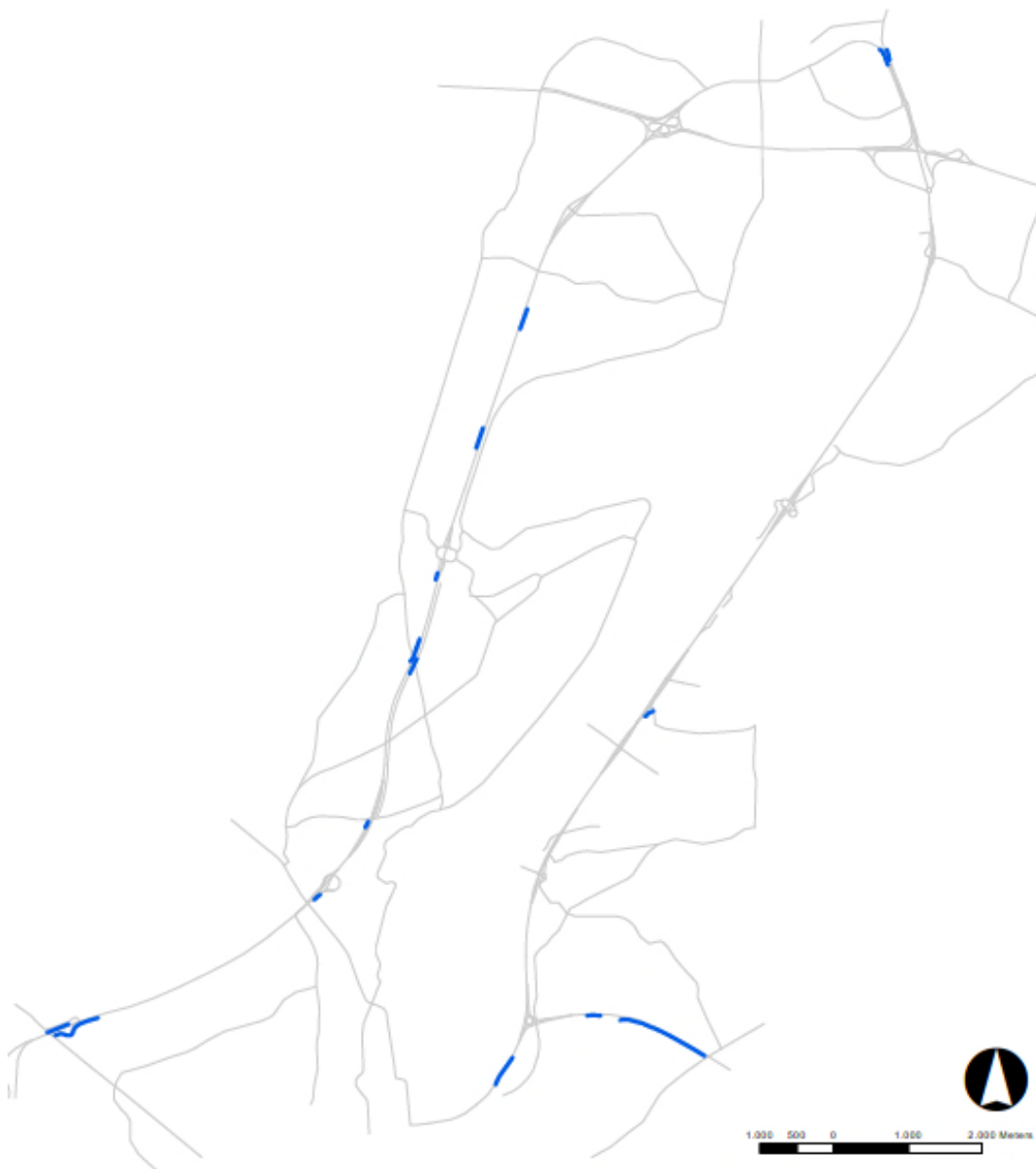
Figuur 6-20 Zones langs R4 zonder schermen of bermen (bestaand, reeds voorzien of opgelegd in MER) waar t.h.v. bewoning Lden > 60 dB(A) in de geplande situatie
