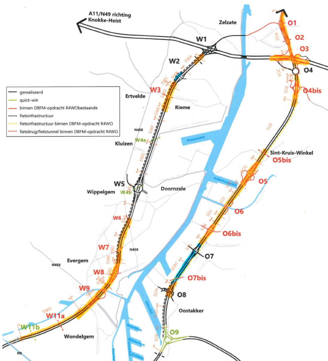
Figuur 6-8 Geplande heraanleg wegdek R4 in SMA-D
