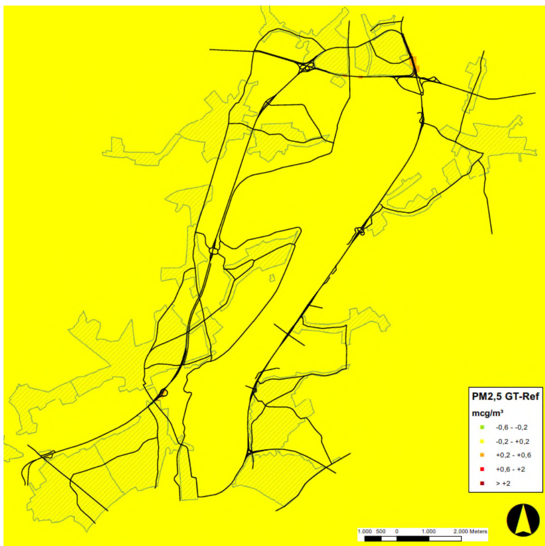
Figuur 7-11 Bijdrage (verschil geplande – referentiesituatie) PM10 en PM2,5 volgens IFDM Traffic
