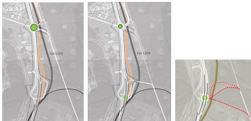
Figuur 5-67: Concepten knoop O4/O4bis: variant 6 (links), variant 8tris (midden) en geoptimaliseerde variant 8tris (= voorkeursontwerp, rechts)
