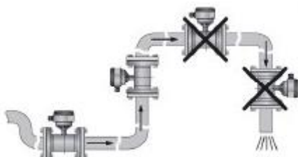
Figuur: correcte installatie op laagste punt (links); foutieve installatie op hoogste punt (boven) en voor open uitlaat (rechts) (Vito, 2019, Code van goede praktijk voor installatie, onderhoud en controle van meetinrichtingen voor opgepompt grondwater)
