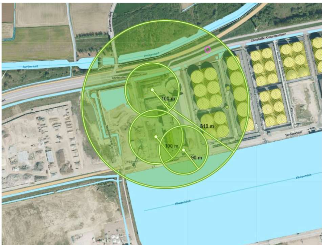
figuur 1: weergave invloedstralen van de bemalingen t.o.v. het centrum van het bemalingskader
