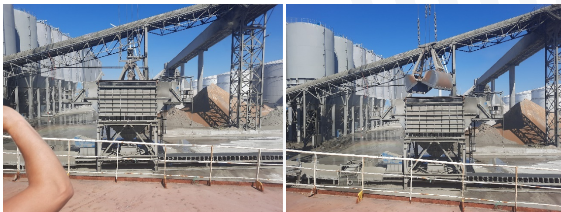
Figuur 5 Lossequentie grijper in storttrechter – voorzichtige handeling zorgt voor geen stofvrijstelling
