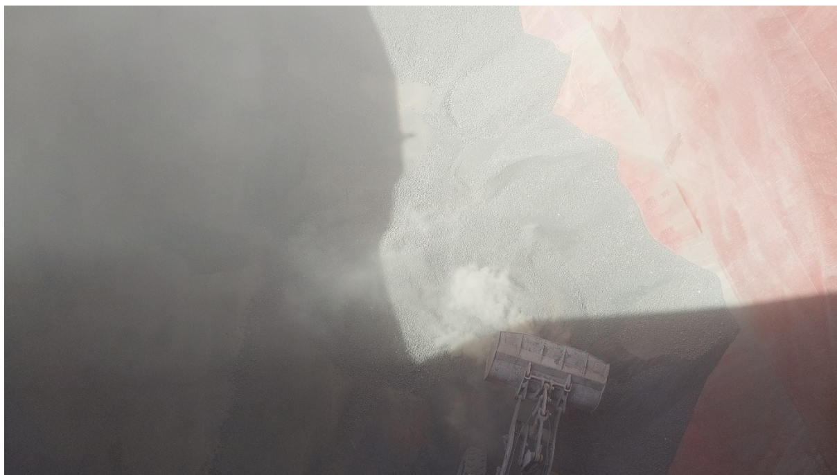
Figuur 9 Stofvrijstelling door manipulatie materiaal door wiellader in opslagruim boot
