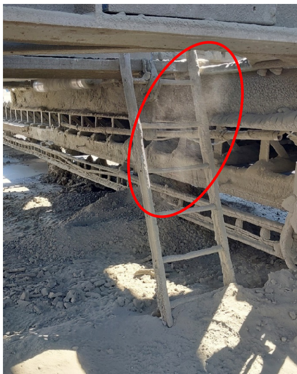
Figuur 6 Stofvrijstelling (rood omcirkeld) aan onderzijde storttrechter
