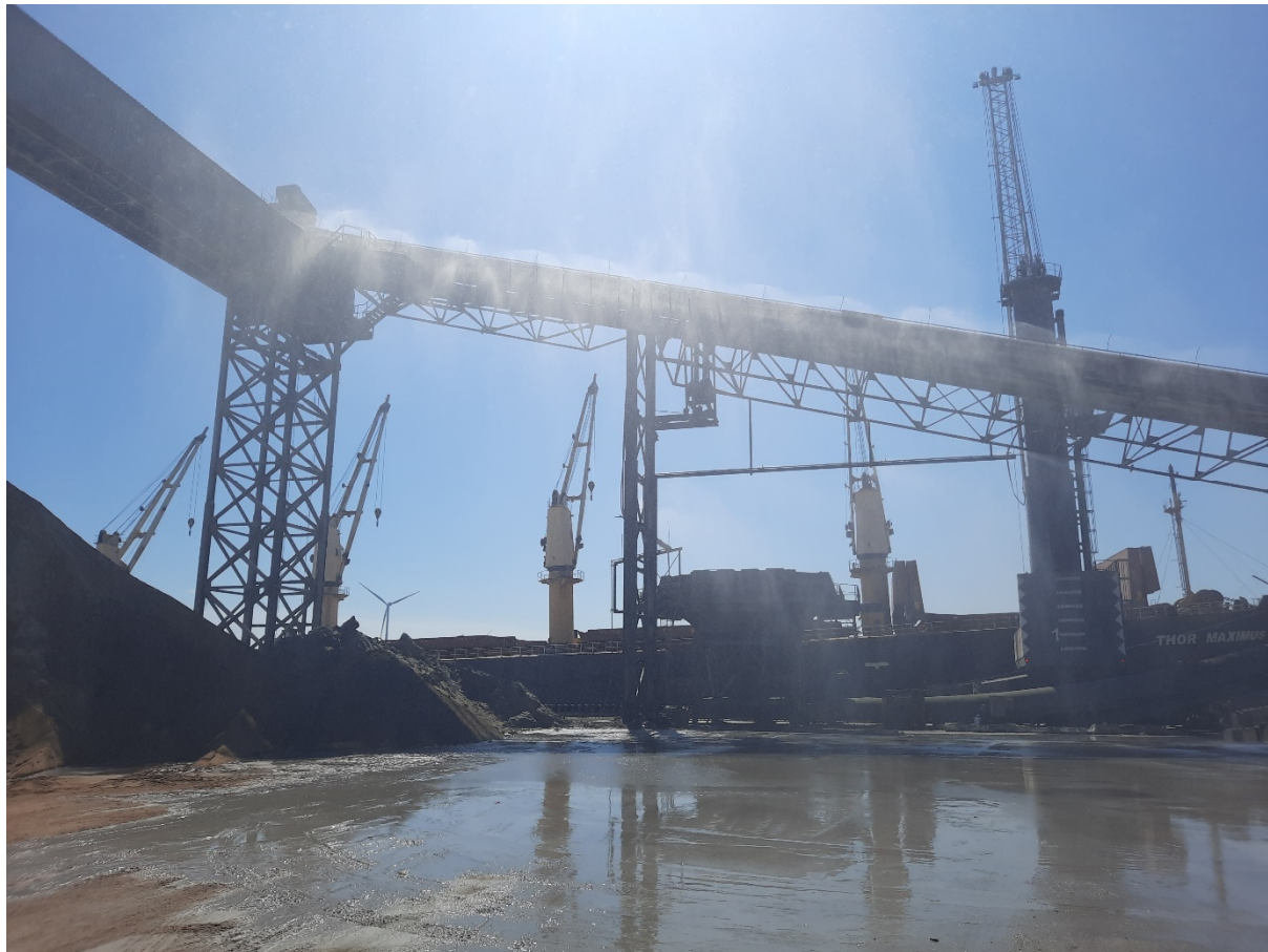
Figuur 8 Watergordijn op grote hoogte tijdens lossen zeeschip bij windrichtingen tussen 90° en 270°
