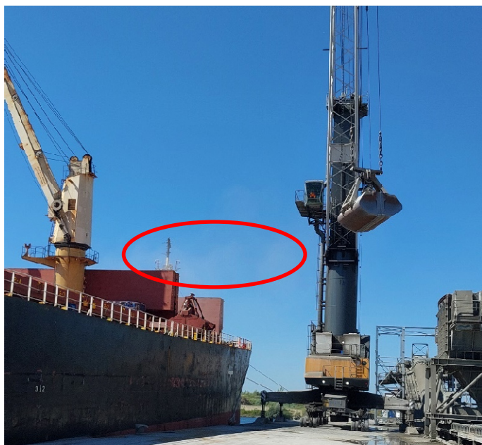
Figuur 4 Grijpkraan met gesloten grijper voor lossen zeeschip. Vrijgesteld stof (rood omcirkeld) is afkomstig uit het opslagruim van de boot
