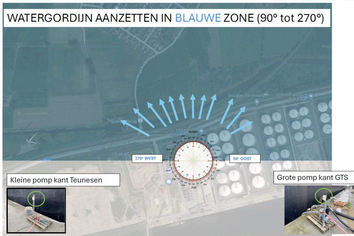
Figuur 3 Beleidsschema aan-/uitschakelen watergordijn tijdens lossen zeeschip
