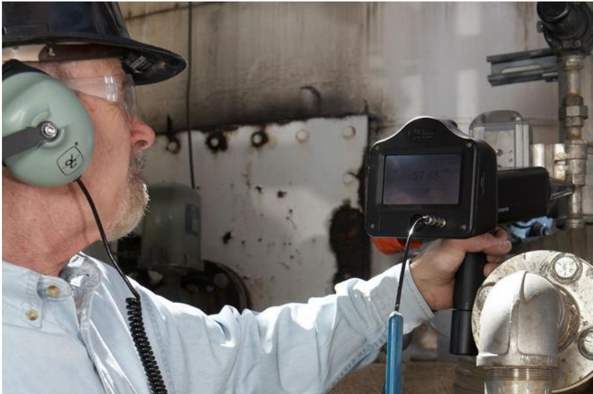
HET OPSPOREN VAN PERSLUCHTLEKKEN MET EEN ULTRASOON DETECTIE APPARAAT (GOOGLE AFBEELDINGEN)
