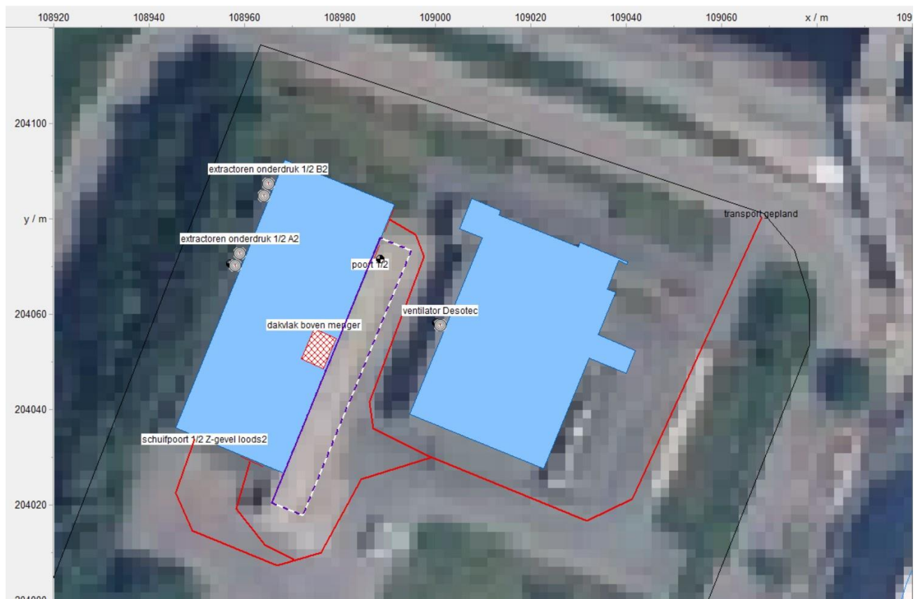
Figuur 8 Detail geluidsmodeel, met aanduiding van de verschillende geluidsbronnen in de geplande situatie
