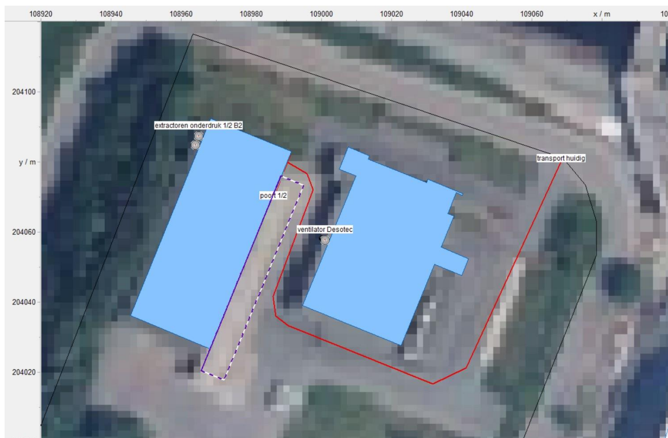
Figuur 7 Detail geluidsmodel, met aanduiding van de verschillende geluidsbronnen in de huidige situatie
