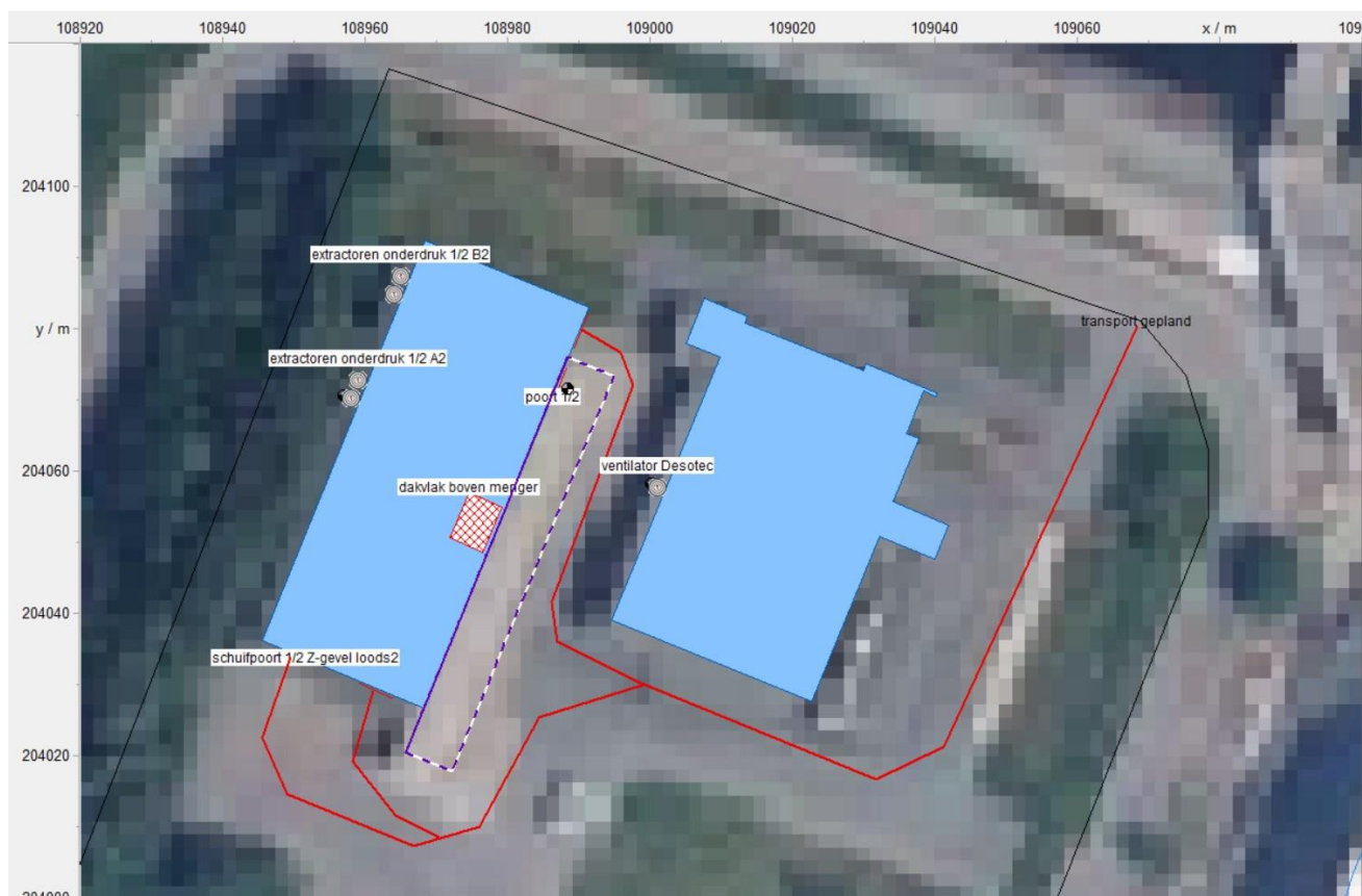
Figuur 8 Detail geluidsmodeel, met aanduiding van de verschillende geluidsbronnen in de geplande situatie
