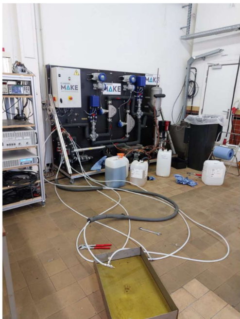
Foto 2: proefopstelling voor testen van sensoren en meters (selectieve inzameling en verwerking van afvalwater als preventiemaatregel)
