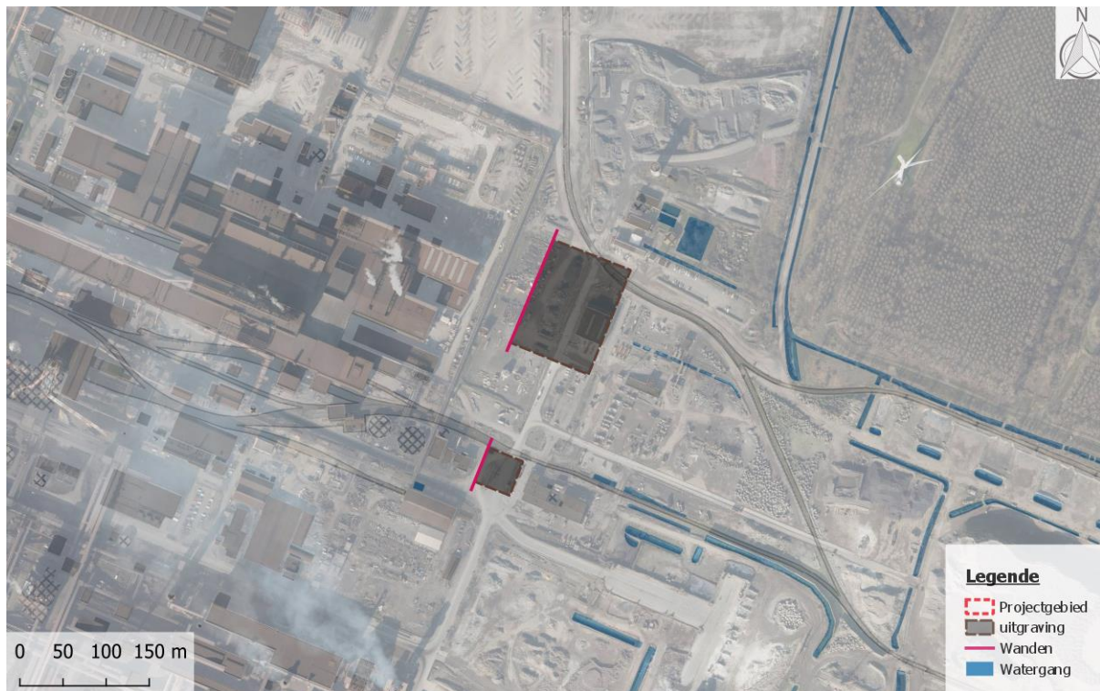
Figuur 3: Inplanting van de uitgravingen met wanden.
