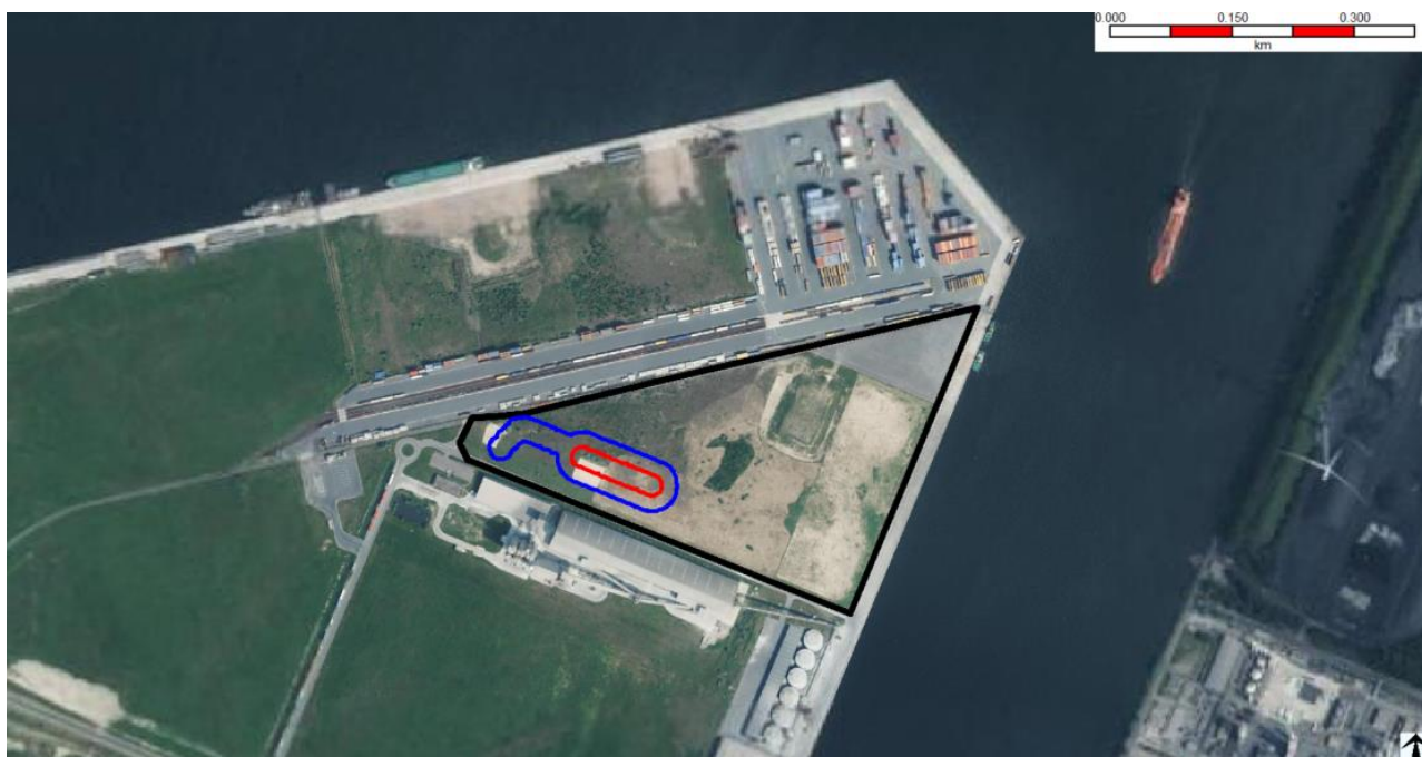
Figuur 4-2 Schadecirkels fakkelbrand (rood: 32 kW/m 2 , blauw: 9.8 kW/m 2 )
