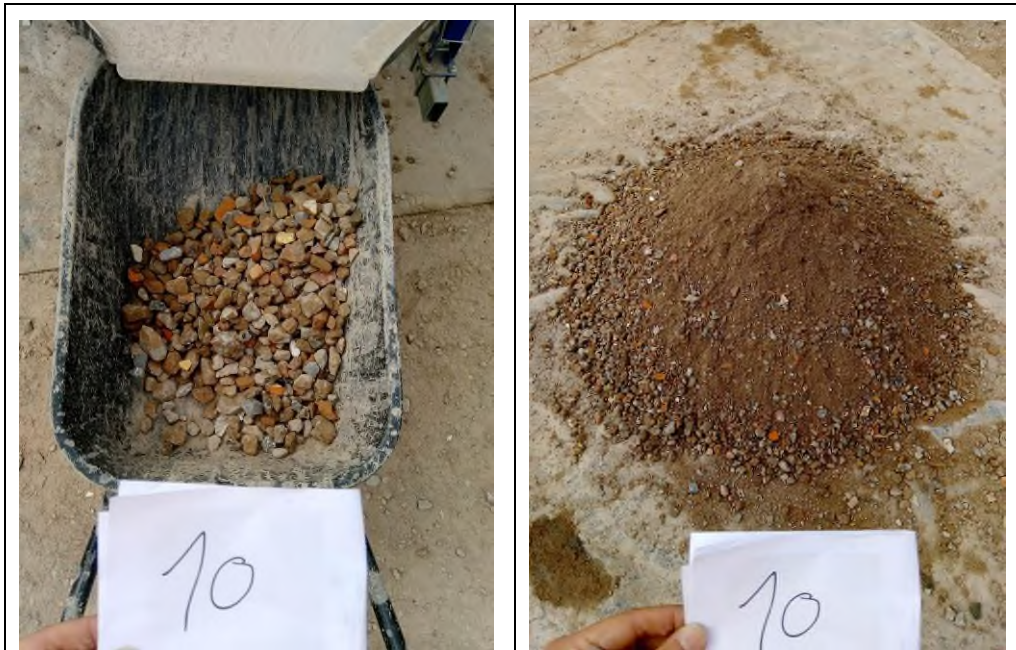
Sleuf 10 grove en fijne fractie
