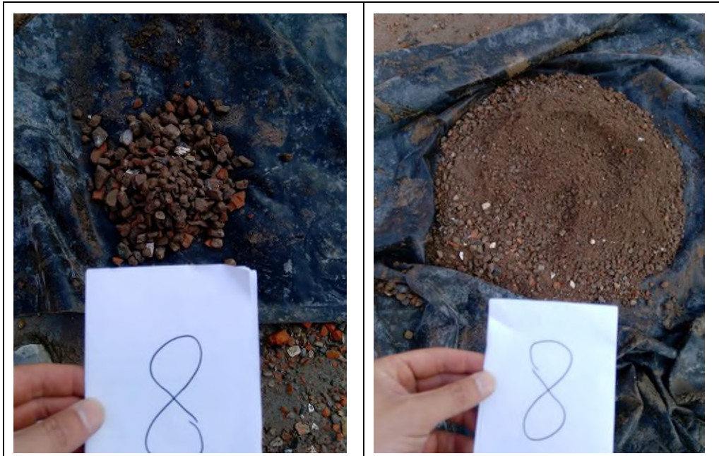
Sleuf 8 grove en fijne fractie
