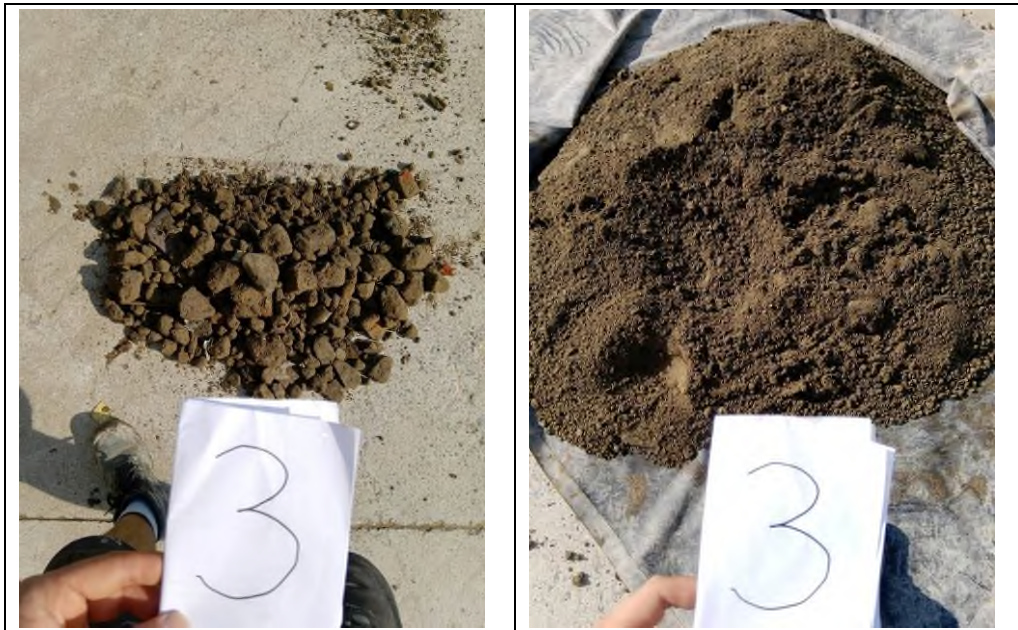
Sleuf 3 grove en fijne fractie
