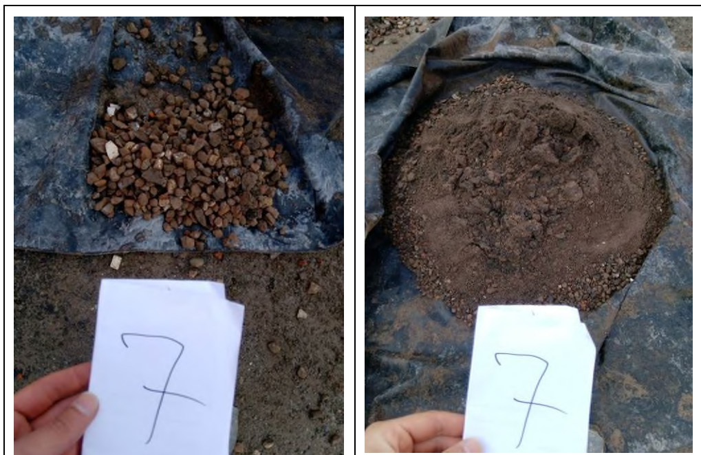
Sleuf 7 grove en fijne fractie
