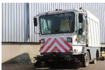
Veegmachine, met water en afzuiging.
