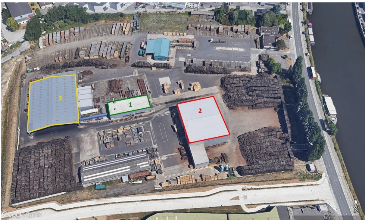
Figuur 1 Woodprotect te Wondelgem – 1 = autoclaaf gebouw voor impregnatie activiteit; 2 = loods met vergunde breekactiviteit; 3 = alternatieve locatie breekactiviteit
