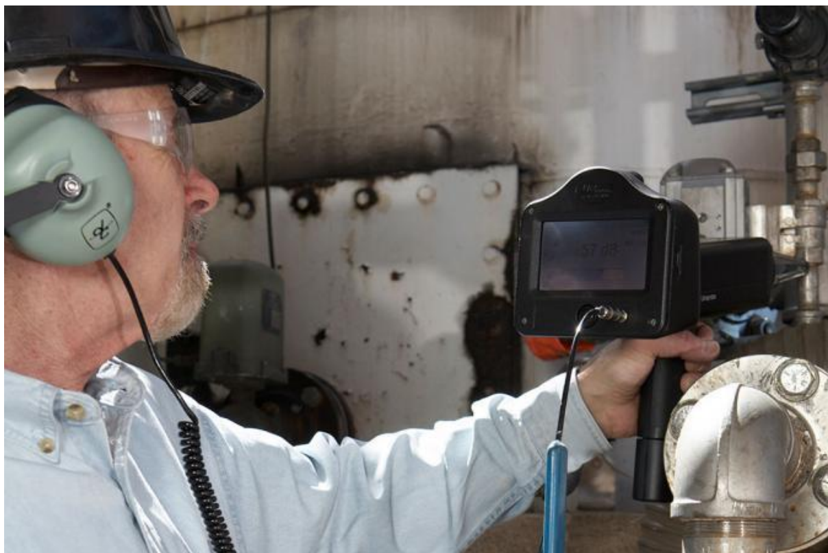
FIGUUR 11: HET OPSPOREN VAN PERSLUCHTLEKKEN MET EEN ULTRASOON DETECTIE APPARAAT (GOOGLE AFBEELDINGEN)
