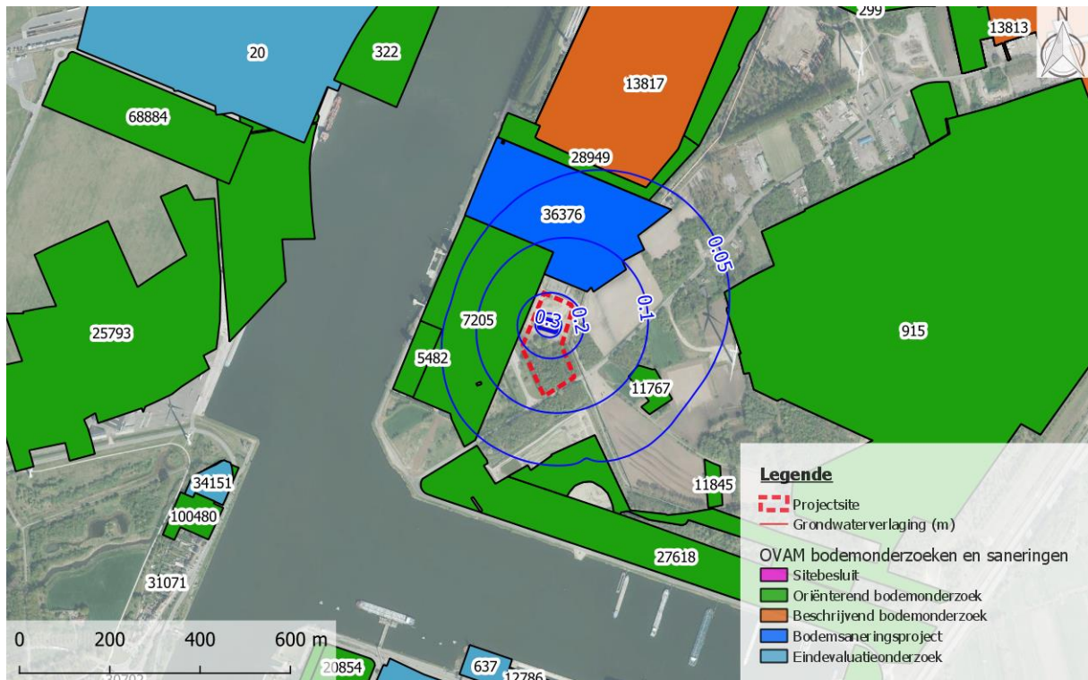
Figuur 57: OVAM dossiers binnen de invloedstraal van de bemaling met Kv L4 van 0,05 m/d.
