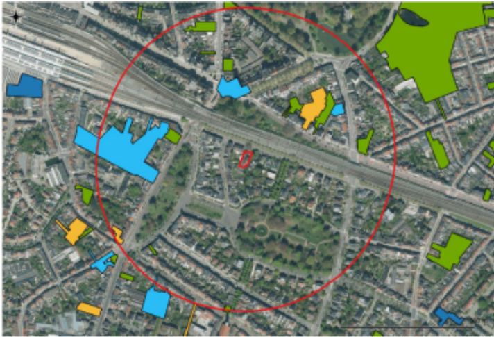
Figuur 20 - minimale invloedstraal van de bemaling (bron: QGIS)
