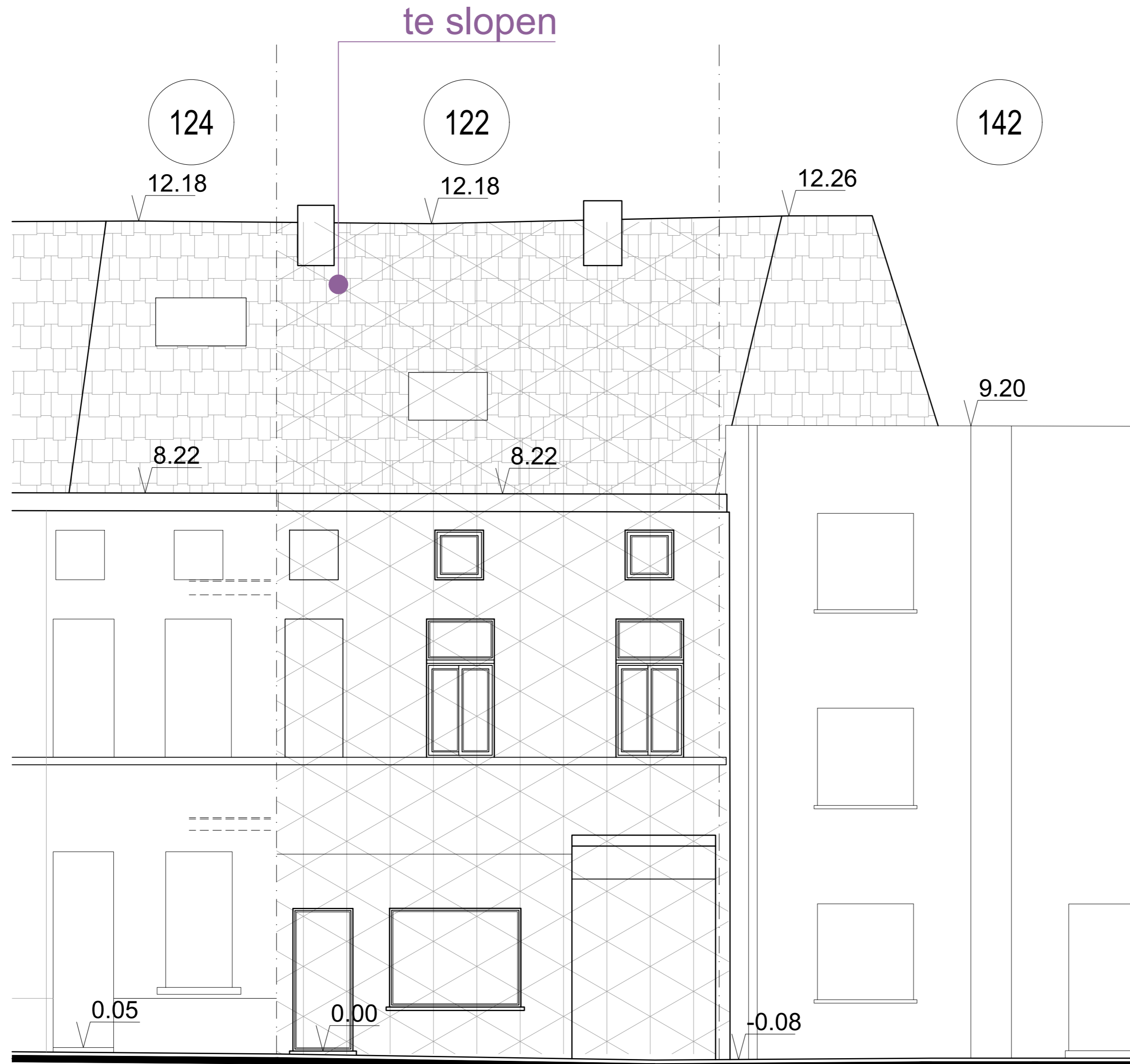
WONING - VOORGEVEL BESTAANDE TOESTAND - TE SLOPEN
